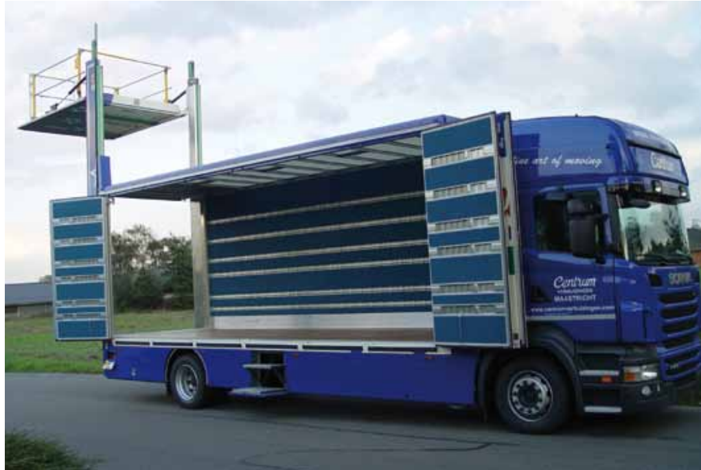
Het openklappen van de panelen resulteert in een geheel vrij overspanning van de totale zijwand.
